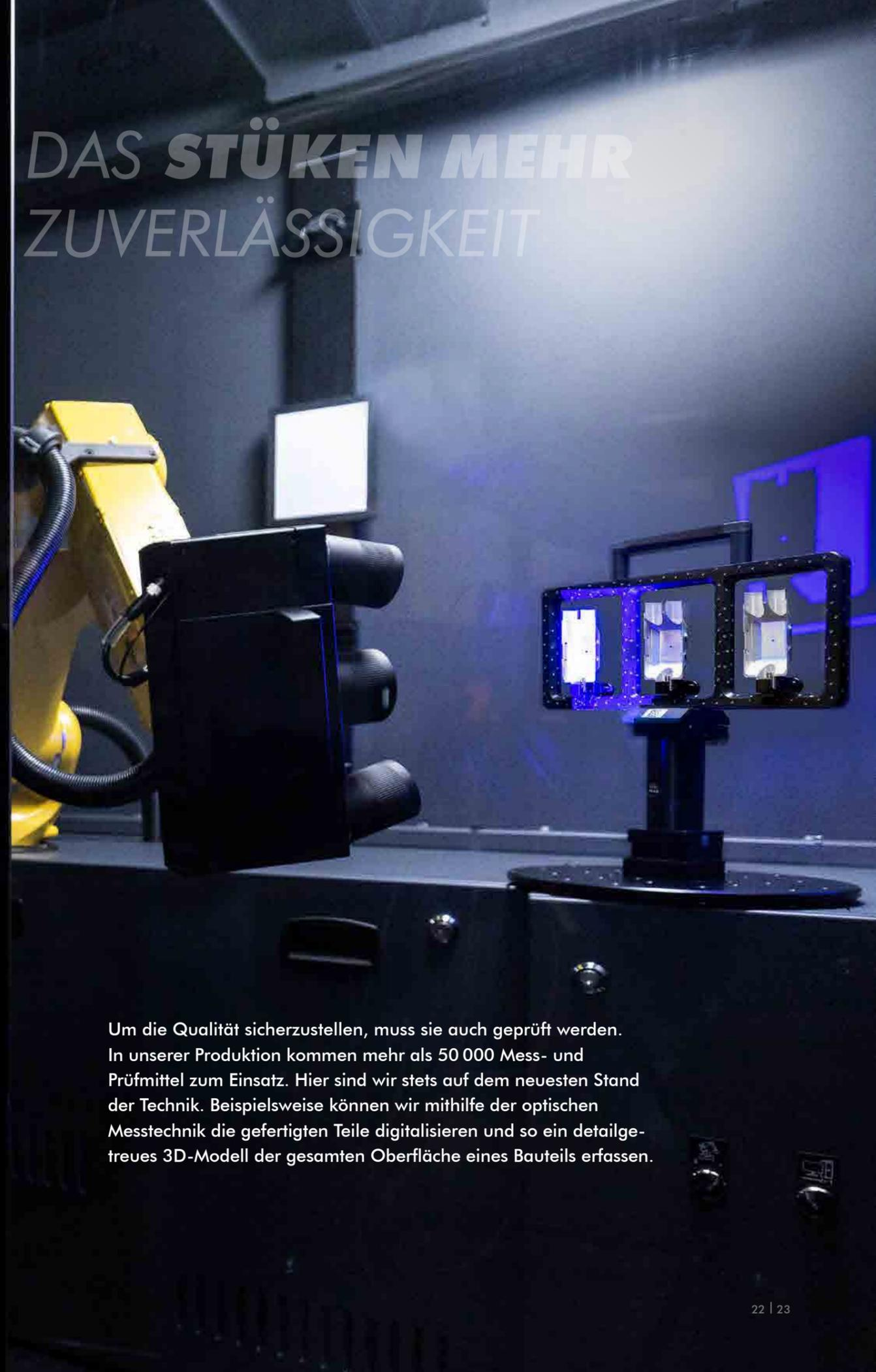
Um die Qualität sicherzustellen, muss sie auch geprüft werden. In unserer Produktion kommen mehr als 50 000 Mess- und Prüfmittel zum Einsatz. Hier sind wir stets auf dem neuesten Stand der Technik. Beispielsweise können wir mithilfe der optischen Messtechnik die gefertigten Teile digitalisieren und so ein detailgetreues 3D-Modell der gesamten Oberfläche eines Bauteils erfassen.
